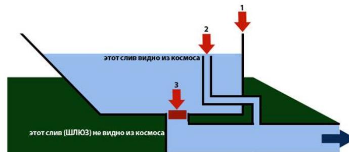
В обычном режиме вода из водохранилища, как только её становится очень много сливается через отверстие (стрелка 2).
